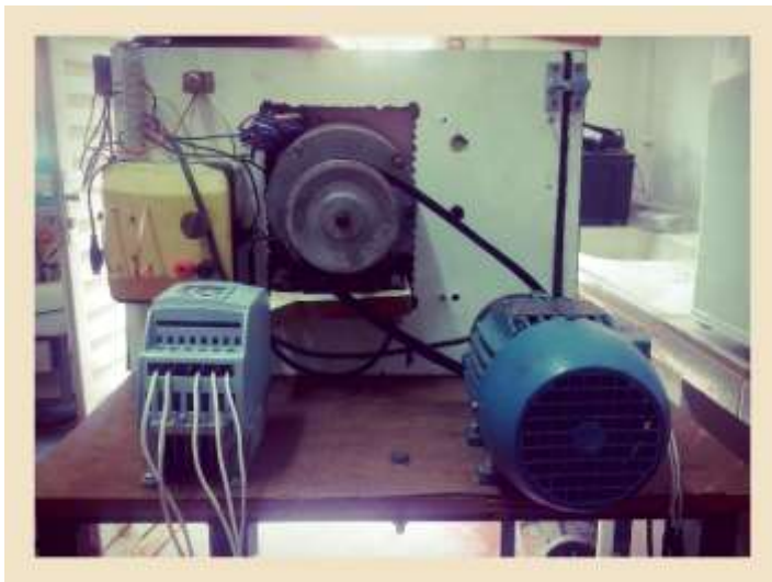
Figura B.1: Motor externo com inversor de frequência acoplado ao ventilador.
