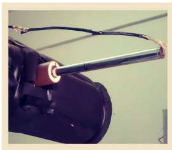
Figura 3.5: Instalação do anemômetro.
