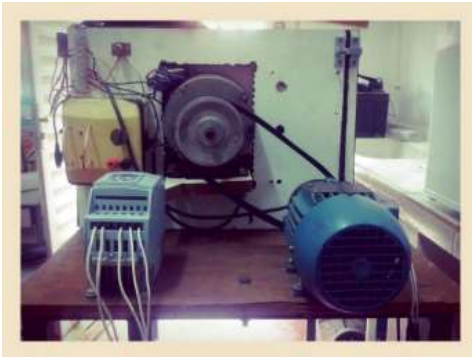
Figura 3.3: Motor externo com inversor de frequência.
